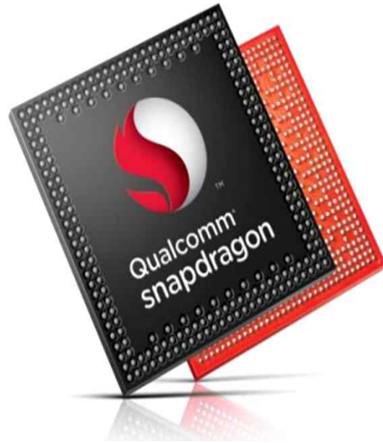
<그림 3-4> 퀄컴의 제로스 및 스냅드래곤 칩 대규모 병렬 구조를 가지고 있으며 인간의 두뇌와 같이 데이터 병렬처리가 가능한 퀄컴의 제로스는 모바일 프로세서로 많이 사용되고 있는 스냅드래곤 칩에 탑재되어 출시되었음
