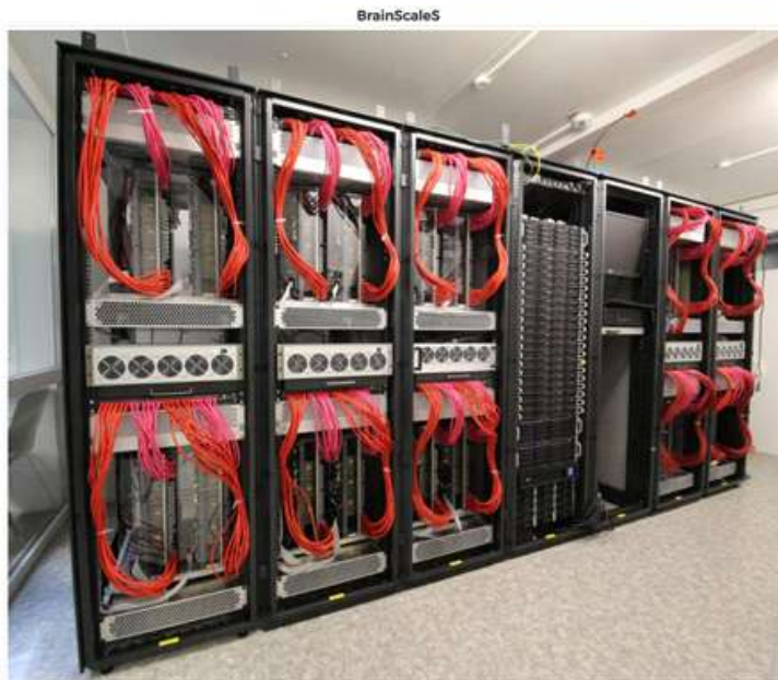
<그림 6-13> 유럽 Human Brain Project(HBP) BrainScaleS 멀티-웨이퍼 시스템 EU가 지원하는 FACETS 프로젝트에서 수행된 연구를 기반으로 하는 시스템으로 약 20만 개의 뉴런과 4천만 개의 시냅스를 상호 연결한 웨이퍼를 사용하는 것이 특징임
