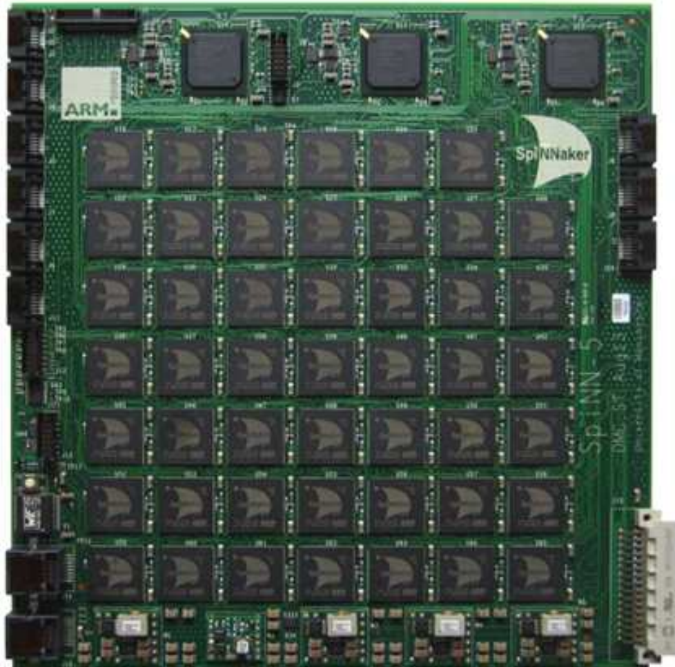
<그림 6-16> SpiNNaker 48-노드 보드(~10만 개 뉴런) 대규모의 스파이크 신경 네트워크로 구성되어 있으며, 최대 10만 개의 뉴런(작은 곤충 뇌의 규모)에 적합함
