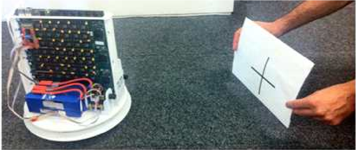
<그림 6-17> SpiNNaker 48-노드 보드 이용 기호 인식 로봇 수직방향, 수평방향을 인식하는 두 운동 뉴런을 구성하여 로봇의 움직임을 결정함.
