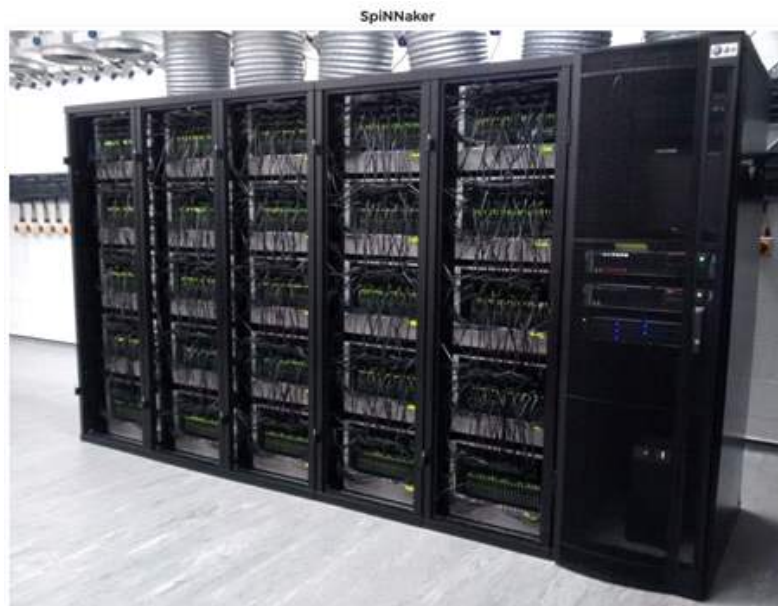
<그림 6-14> 유럽 Human Brain Project(HBP) SpiNNaker 멀티-랙 시스템(~1억개 뉴런) 50만 개의 코어 SpiNNaker 머신은 25세트의 24 보드 케이스를 통합하여 수 억 개의 뉴런에 신경 네트워크를 동작 시키는 데 적합함
